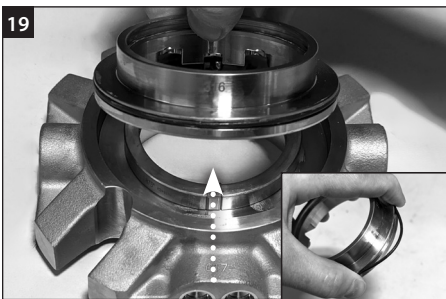
从压盖上取下适配器。取下适配器 O 型环 (Z) 并丢弃。将适配器放在一边。
